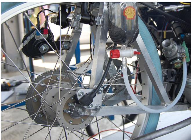
*Le nouveau moyeu arrière, avec la roue libre, une vue partielle du réservoir (100cc !), le capteur de vitesse pour le boîtier de commande du moteur et, en arrière-plan, la transmission à deux étages*
