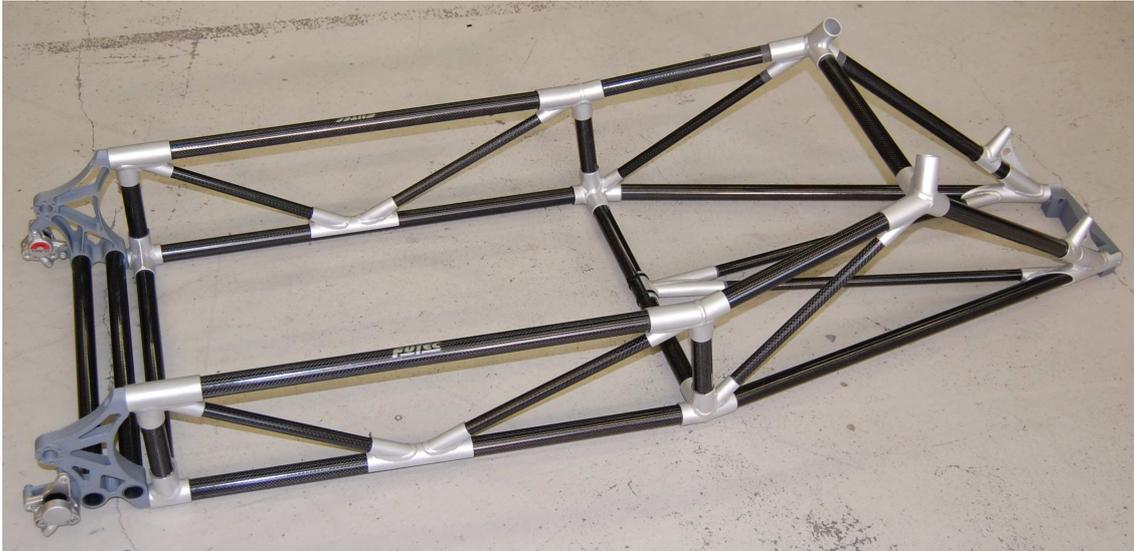
*Le nouveau châssis étudié et réalisé par Futec en fibre de carbone et aluminium.
